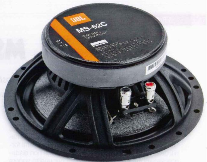
L'ogiva centrale funge da rifasatore acustico, per estendere la risposta verso le alte frequenze, ed agevola la ventilazione della bobina mobile attraverso l'apertura circostante. Ulteriori aperture per la ventilazione sono ricavate nel cestello in prossimità del magnete.
